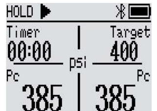
Imagen 2 - Interfaz de la prueba de estanqueidad
