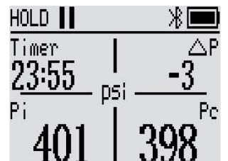
Imagen 3 - Interfaz de la prueba de estanqueidad
